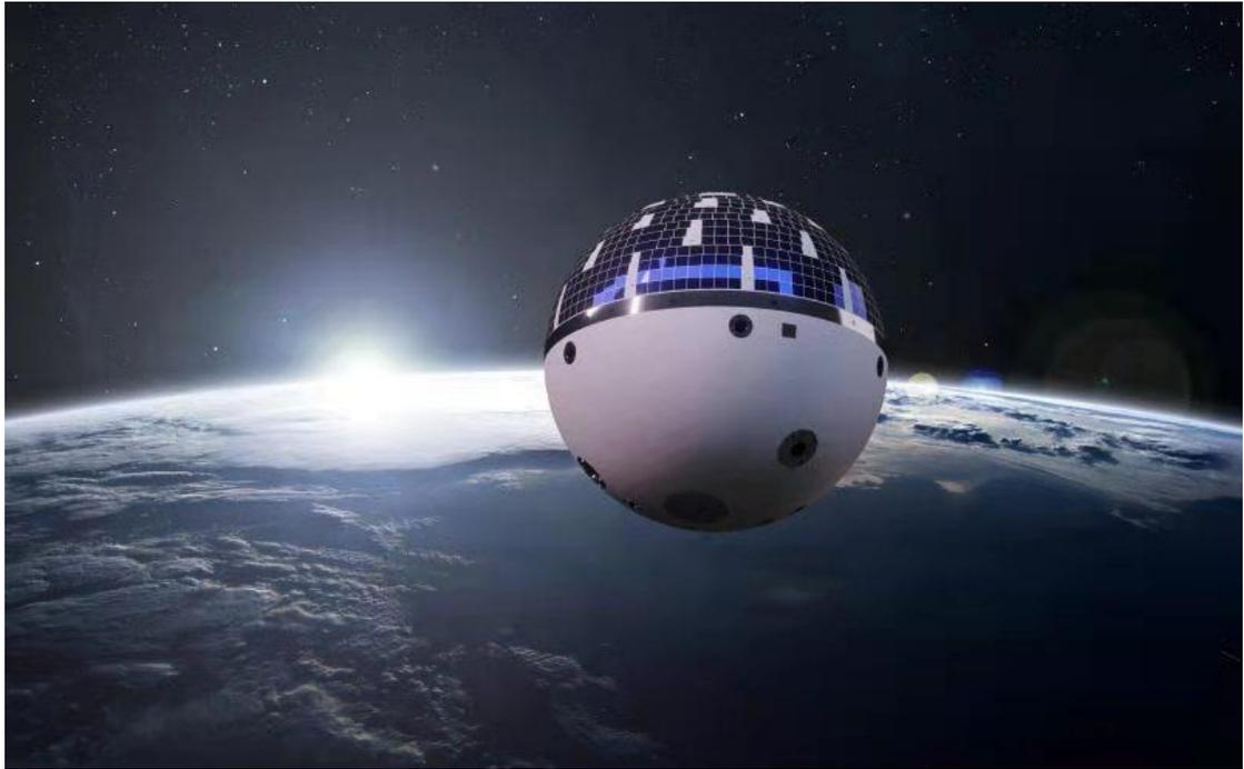
这颗命名为明日科技之星（轨道大气密度探测试验卫星）的小卫星，由中国科学院微小卫星创新研究院抓总研制，计划于 2021 年 12 月在某卫星发射中心发射。该卫星将进行低成本大气密度实时探测技术验证，构建高精度大气密度预测保障服务体系的“探”环节，建立我国自主中低轨大气密度模型。
